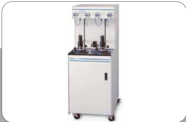
Automated Mercury Prosimeters, Micromeritics, Autopore IV بررسی ساختار، سطح، حجم و توزیع حفرات در محدوده ۰/۰۰۳ تا ۱۱۰۰ میکرومتر
