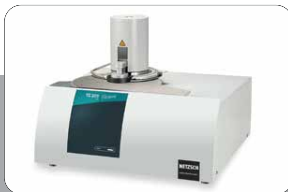
Thermogravimetric Analysis, Netzsch, TG209 F1 وزن سنجی حرارتی و بررسی تغییرات فازی و تعیین آنتالپی واکنش
